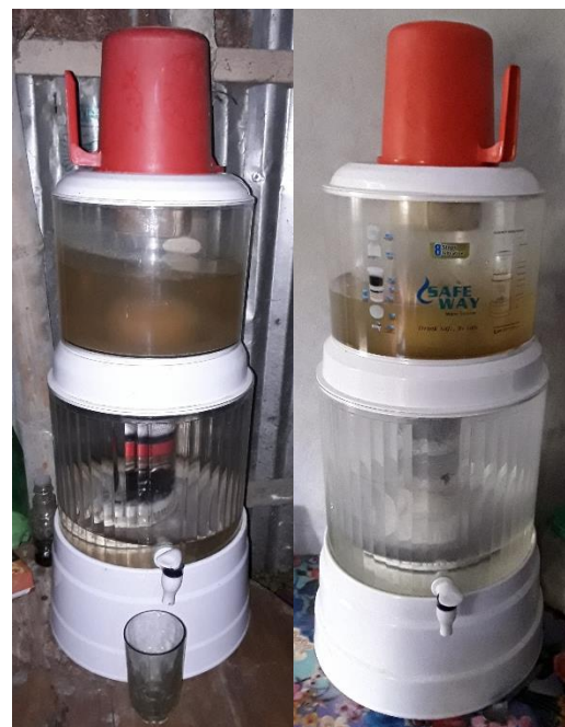
Abb. 1: Zwei Haushaltsfilter mit nachgeschalteter Arsenentfernung.
